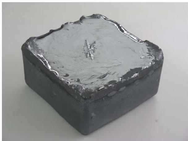
Am SIMTEC des Fraunhofer ISE mittels der »Vertical Gradient Freeze«-Technik hergestellter multikristalliner Siliciumblock von etwa 13 kg. Die Seitenlänge beträgt ca. 22 cm, woraus sich eine einzelne Säule vom Format 156 x 156 mm<sup>2</sup> sägen lässt.
