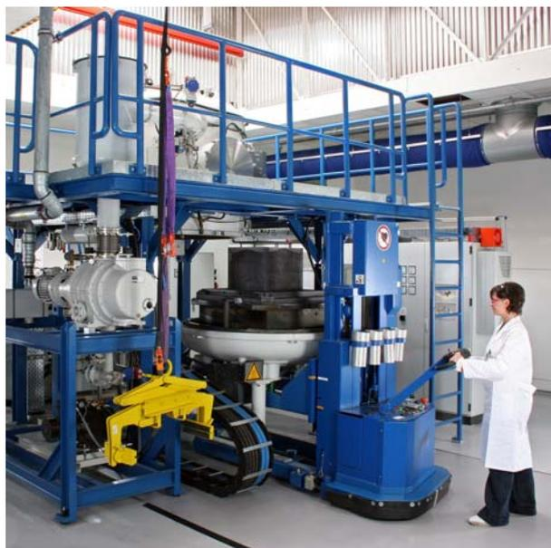
Kristallisationsanlage zur Herstellung von multikristallinen Siliciumblöcken.
