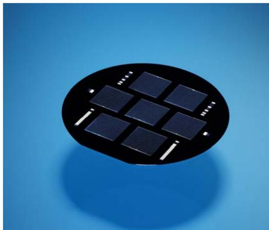
4 Zoll Wafer mit sieben 4 cm<sup>2</sup> großen hocheffizienten n-Typ Silicium-Solarzellen mit Wirkungsgraden bis zu 23.4%.
