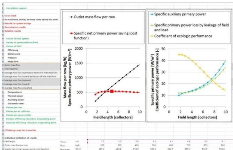
Kleine Parameterstudie auf Basis von Aircow mit individuellen Diagrammen zur Visualisierung der Modellergebnisse. ©Fraunhofer ISE
