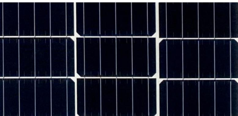
Am Fraunhofer ISE hergestelltes Vollformatmodul. Die Zellverbinder sind direkt mit den Kontaktfingern verklebt.
