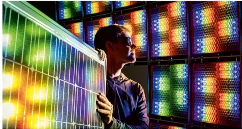
LED-Modulsimulator zur Charakterisierung und Zertifizierung von großflächigen Tandemphotovoltaik-Modulen.
