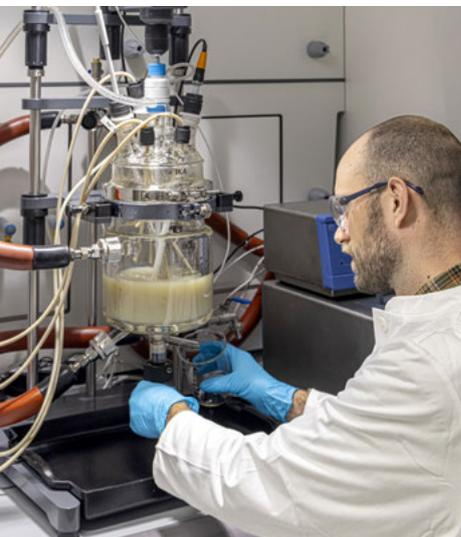
*In den Batterieforschungslaboren am Fraunhofer ISE werden Präkursoren für Kathodenaktivmaterialien für Natrium-Ionen-Batterien synthetisiert.*
