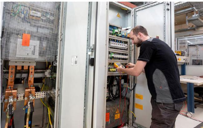
*Vorbereitung eines netzbildenden Wechselrichters zur Vermessung im Multi-Megawatt-Lab.*
