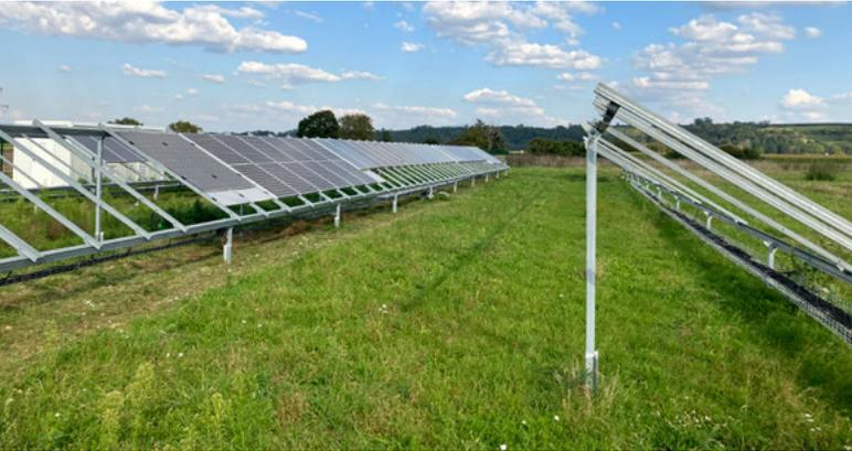
*Belegte und freie Messplätze für Einzelmodule auf dem Testfeld des Fraunhofer ISE in Merdingen.*
