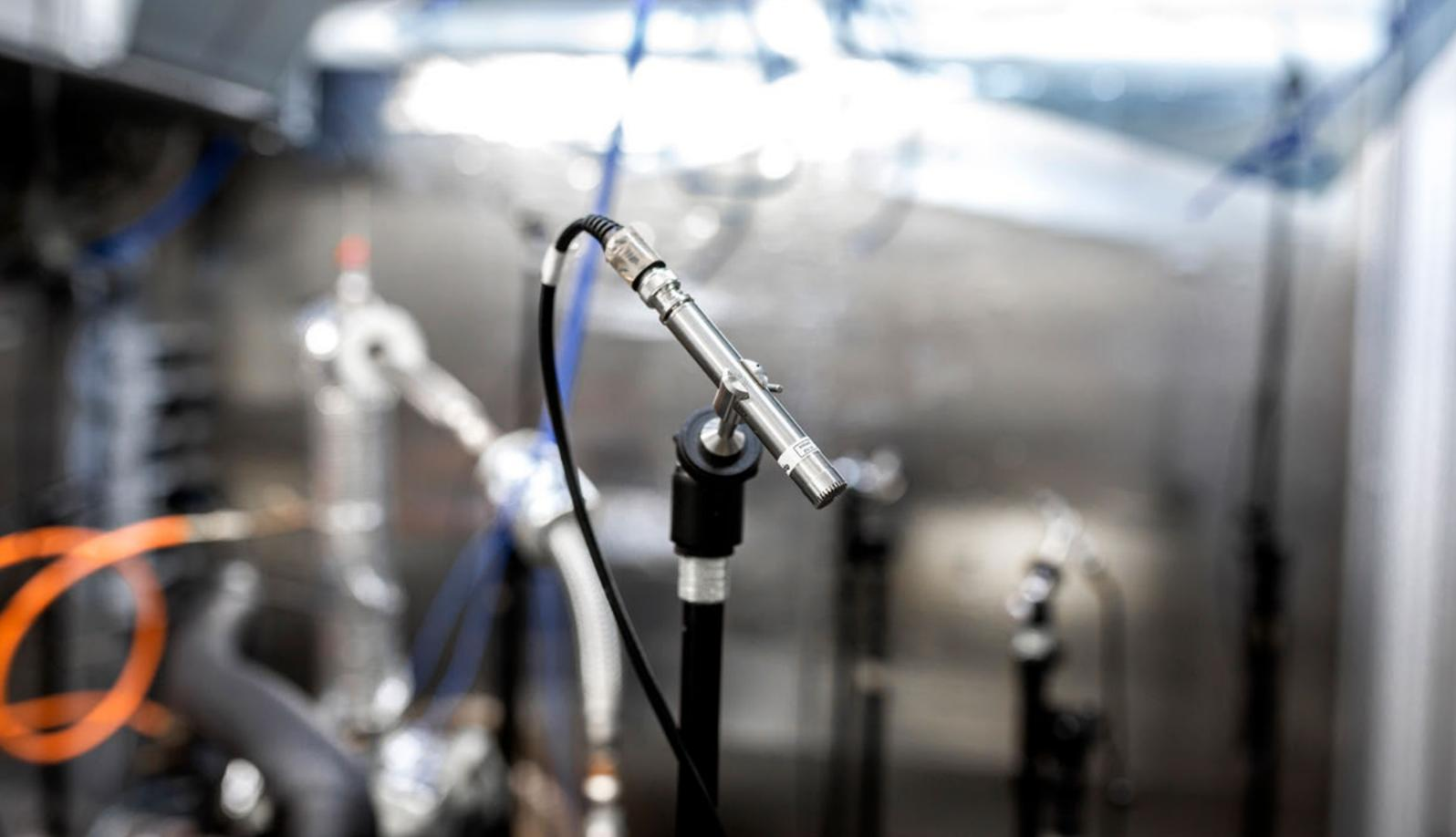
Teststand zur Charakterisierung von Verdichtern für Kältekreise in Wärmepumpen und Kältemaschinen.
