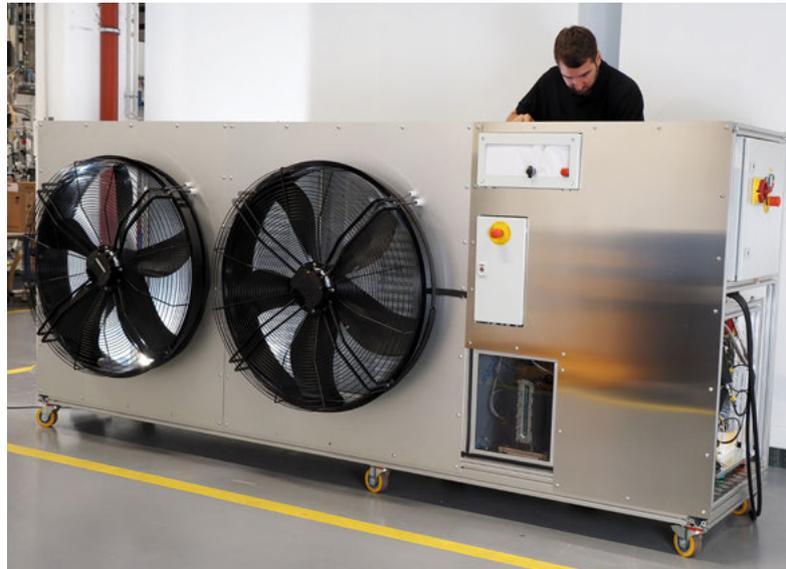
*Kältemittelreduzierter Wärmepumpenprüfling für die Außenaufstellung mit 25 bis 30 kW Leistung, entwickelt und aufgebaut am Fraunhofer ISE.*
