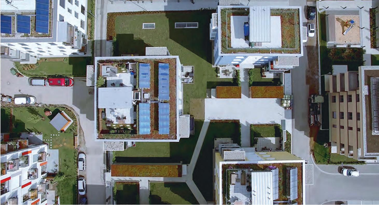
Das Fraunhofer ISE entwickelt Gesamtlösungen für klimaneutrale Gebäude, Quartiere und Kommunen. Im Bild zu sehen ist das Freiburger Quartier Gutleutmatte, in dessen Nahwärmenetz dezentrale Solarthermieanlagen integriert wurden.
