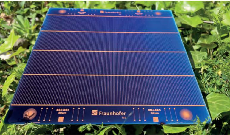
*TOPCon-Solarzelle metallisiert mit reiner Kupferpaste (Testlayout).*
