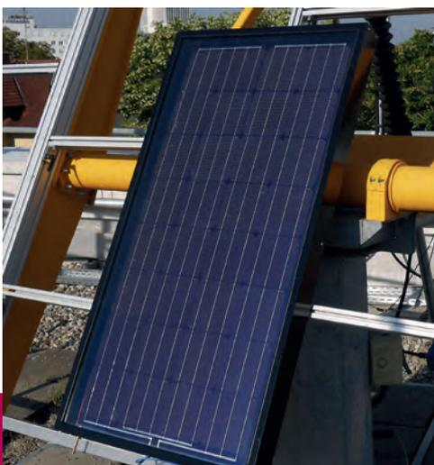
Abgedeckter PVT-Kollektor mit Low-E-Verglasung beim Leistungstest auf dem Außenteststand des TestLab Solar Thermal Systems am Fraunhofer ISE.
