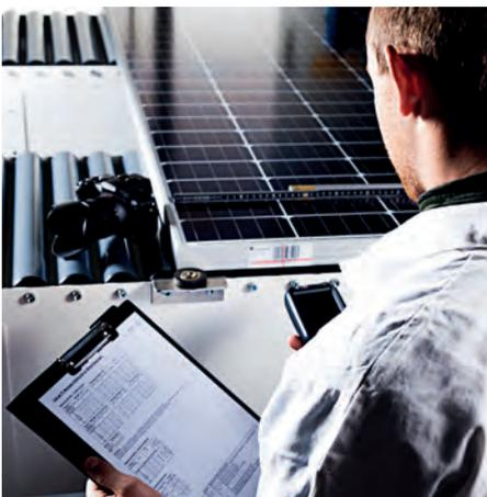
*Eingangsprüfung eines PV-Moduls.*
