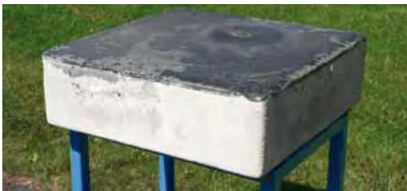
Abb. 2: Kristallisierter Siliziumblock aus hochdotierten »tops and tails«, einem Abfallmaterial der Mikroelektronikindustrie. Der Block hat eine Grundfläche von etwa 68x68 cm<sup>2</sup> und wiegt bei einer Höhe von ca. 25 cm etwa 270 kg.
