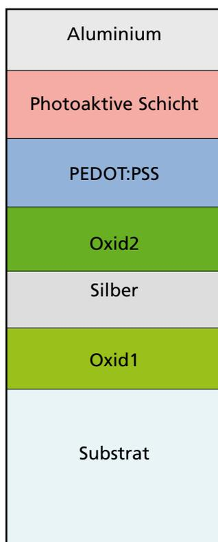
Abb. 1: Schematischer Schichtaufbau einer organischen Solarzelle mit transparenter Silberelektrode.
