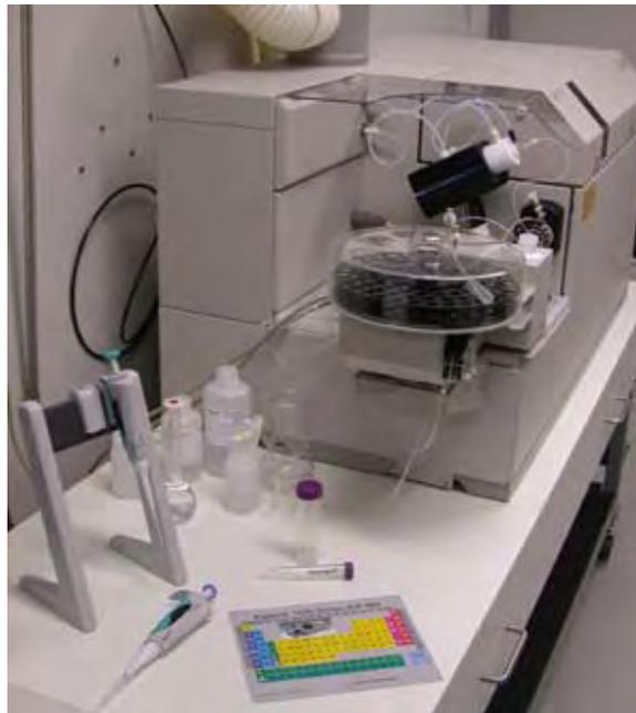
Abb. 5: Mit unserem Inductively Coupled Plasma (ICP) Spektrometer können wir Korrosionsprodukte oder Katalysatorpartikel aus dem Brennstoffzellenbetrieb nachweisen, um optimierte Materialien zu verifizieren.
