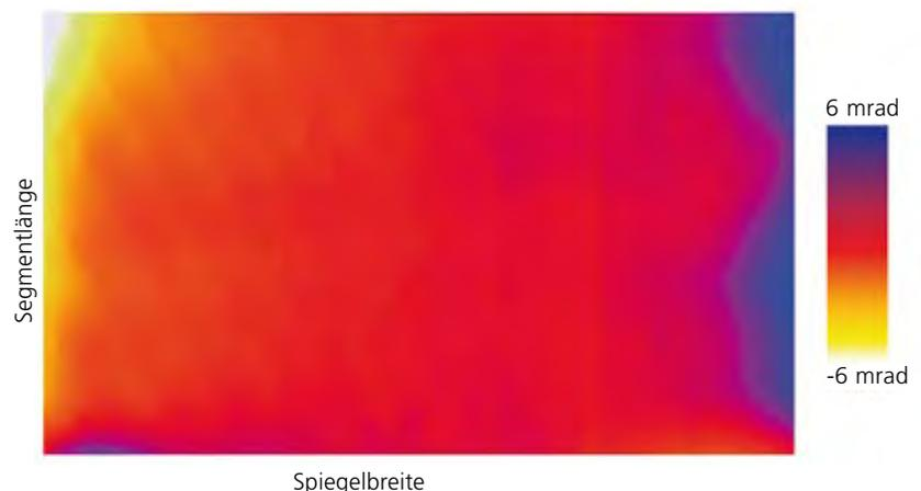
Abb. 4: Spiegelsegment: Lokale Winkel-Verteilung der Abweichung von den idealen Oberflächenwinkeln in mrad. Deutlich sind systematische Abweichungen am Rand des Spiegels zu erkennen, die durch die Fertigung verursacht wurden. Die Formtreue wird auch statistisch bewertet, dieses Segment hat eine Standardabweichung von 1,6 mrad.
