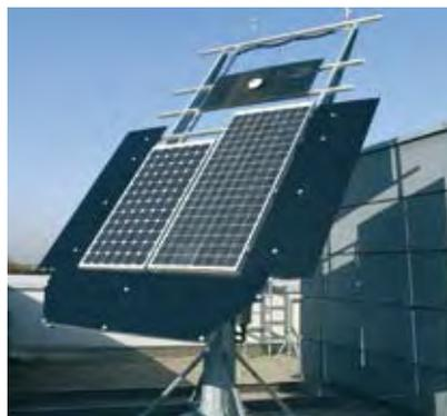
Abb. 1: Prüfstand zur Bestimmung der »Nominal Operating Cell Temperature« (NOCT). Der einachsige nachgeführte Tracker ermöglicht eine Verkürzung der notwendigen Prüfzeiten.
