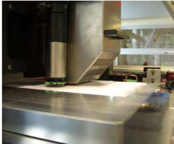
Abb. 1: Präzisions-Inkjet-Anlage am Fraunhofer ISE für die Bedruckung von Siliziumwafern mit Hotmelt-Pasten. Die Anlage ist in der Lage, mit unterschiedlichen Pasten und Druckkopfmodulen zu arbeiten. Es steht darüber hinaus ein einfacheres Drucksystem zur Verfügung, mit dem neue Pasten und Druckköpfe getestet werden können, bevor sie in das Hauptgerät übernommen werden.
