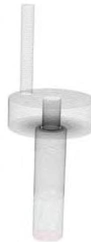
Abb. 1: Die Diskretisierung der Reaktor-Geometrie mit Mischkammer, Reaktionszone (Katalysator) und Auslasszone dient als Eingabedatei der eigentlichen CFD-Simulation. Die Abbildung zeigt die Vernetzung eines autothermen Kerosinreformers, bei dem über das oben dargestellte Rohr verdampftes Wasser-Luft-Gemisch zugegeben wird. Dieses Gemisch wird über einen Ringspalt in den Reaktorraum überführt. Im Ringspalt geben wir zentral über eine Einstoffdüse flüssiges Kerosin zu.
