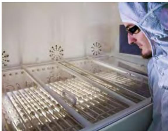
Abb. 1: Inline-Galvanikanlage (Silber) am Fraunhofer ISE. Deutlich zu erkennen sind die Beleuchtungsquellen im Bad.
