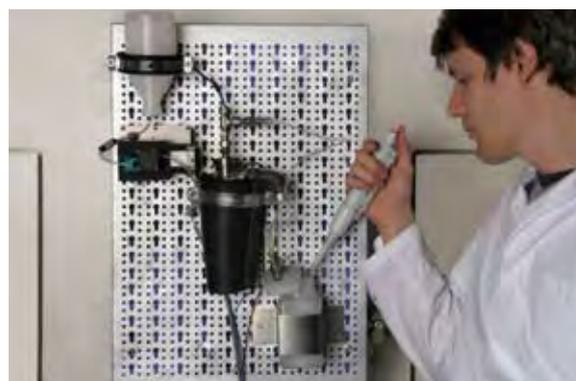
Abb. 2: Versuchsaufbau zur Erprobung verschiedener Reaktortypen eines Wasserstoffgenerators auf Basis chemischer Hydride bestehend aus Vorratsbehälter, Dosierpumpe, wärmeisoliertem Reaktor und Auffangbehälter. Zur optimalen Auslegung des Systems ist eine genaue Kenntnis der möglichen Reaktionspfade der Wasserstoff-Freisetzung erforderlich.
