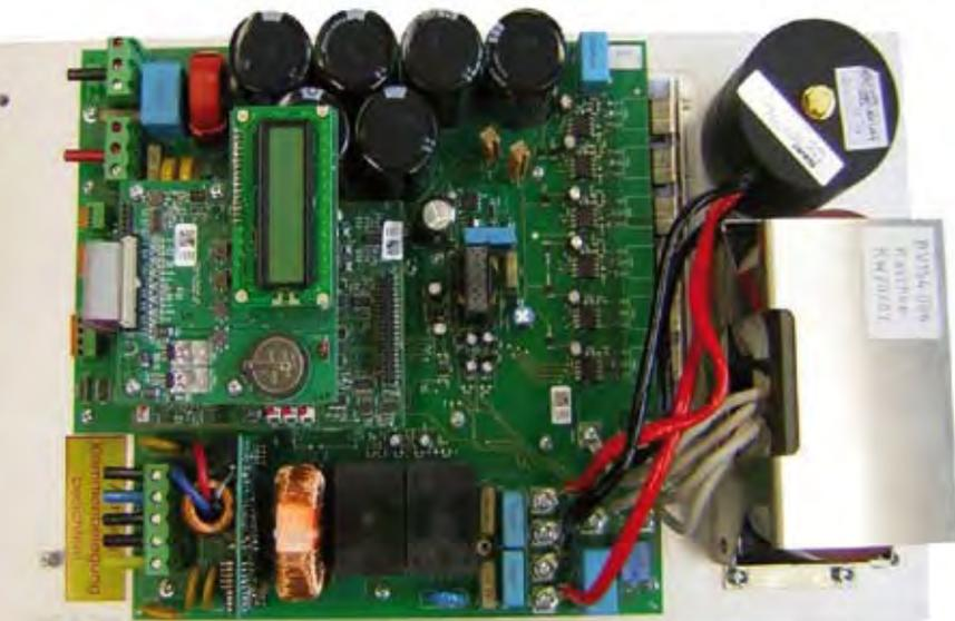
Abb. 1: Einphasiger PV-Wechselrichter in HERIC®-Topologie. 5 kW Nennleistung, 350 V Zwischenkreisspannung und 16 kHz Schaltfrequenz. Die Entwicklung erfolgte im Auftrag eines Industriepartners.
