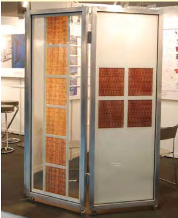
Abb. 1: Messe-demonstrator – aufgebaut aus mehreren Farbstoffsolarmodulen (30 cm x 30 cm), die als Glasverbund zwischen Architekturglas einlamiert sind. Als Einbaumöglichkeiten werden der semi-transparente Verbund (links) in einer Glasfassade und die Integration in einer Kaltfassade (rechts) aufgezeigt.
