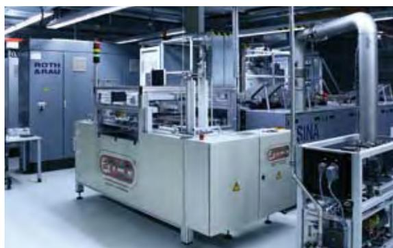
Abb. 2: Automatisierte, industrielle PECVD-Anlage zur Inline-Abscheidung von amorphem Silizium, Siliziumnitrid und Siliziumdioxid.
