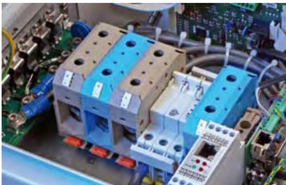
Abb. 1: PV Laderegler »Taron« der Firma Steca für 24 V/70 A mit UESP-Interface. Das UESP-Interface besteht aus einem kleinen Embedded System der Firma SSV mit einem 32 Bit Coldfire Prozessor (unten rechts im Foto). Das Fraunhofer ISE hat in dieses Interface das UESP-Protokoll samt Netzwerkmanagement unter dem Betriebssystem Linux implementiert. Dasselbe Embedded System wird für das CANopen-Interface des »Energy Dispensers« (Abb. 2) verwendet.
