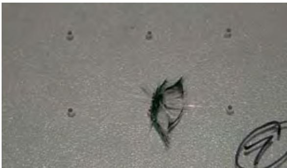
Abb. 2: Schädigung eines Versuchsmusters aus der Entwicklung durch Aufprallen einer Stahlkugel. An den hier verwendeten und als ungeeignet geprüften Abstandshaltern bricht das Glas.
