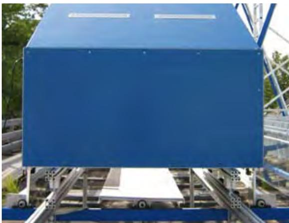
Abb. 3: Apparatur zur Vermessung der Formtreue von schmalen Spiegeln. Hier bei der Vermessung eines Spiegels des Demonstrationskollektors der PSE GmbH in Freiburg. Die Formtreue der spiegelnden Komponenten wird überprüft.
