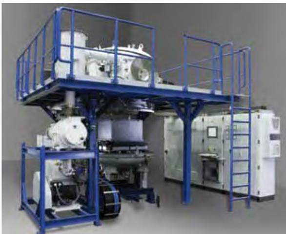
Abb. 1: Unsere Anlage (Höhe 3,5 m) für die Kristallisation multikristalliner Siliziumblöcke, nah am derzeitigen Standard der Photovoltaikindustrie. Sie zeichnet sich durch ihre hohe Flexibilität aus: wir können damit Blöcke in variablen Größen mit einer Grundfläche von ca. 20x20 cm<sup>2</sup> bis zu einer Größe von 68x68 cm<sup>2</sup> herstellen. Mehrfach vorhandene Heizersätze ermöglichen uns, auch sehr unterschiedliche Siliziumqualitäten zu kristallisieren und zu charakterisieren.
