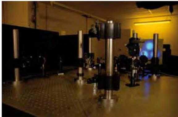
Abb. 3: Optischer Aufbau zur Dreistrahl-Interferenzlithographie. Ein Laserstrahl wird in drei gleichstarke Strahlen geteilt, welche aufgeweitet und auf der mit einem photoempfindlichen Lack beschichteten Probe zur Überlagerung gebracht werden. Das resultierende Interferenzmuster weist eine hexagonale Symmetrie auf.
