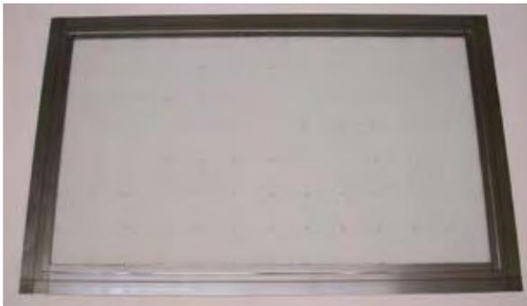
Abb. 1: Ansichtsmuster eines Vakuum-Isolierglases mit Glas/Metall-Randverbund (ungerahmt und ungesäumt) und Abstandshaltern aus Glas.
