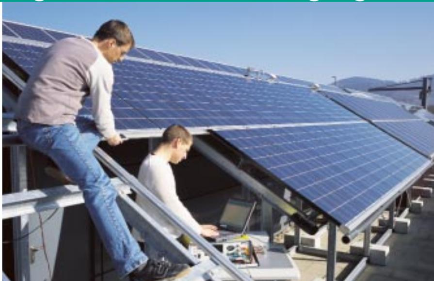
Leistungsvermessung einer Photovoltaik-Anlage durch Experten des Fraunhofer ISE. Vergleiche zeigen, dass die tatsächliche Leistung des Produkts häufig die angegebenen Toleranzen überschreitet. In Kooperation mit acht Herstellern und drei Prüflaboren entwickelt das Fraunhofer ISE jetzt ein Verfahren für die Verbesserung der Genauigkeit und Vergleichbarkeit der Leistungsmessung von mono- und multikristallinen Silicium-Solarmodulen (Beitrag S. 74).
