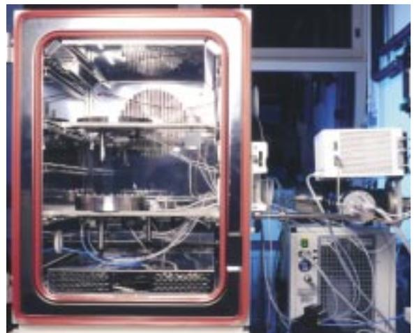
Abb. 3: Permeations-Messung von Hoch-Barrieriefolien mittels Massenspektrometrie. Diese Folien werden beispielsweise als Rückseitenfolie für Photovoltaik-Module oder als Außenhülle für Vakuum-Isolationspaneele verwendet.
