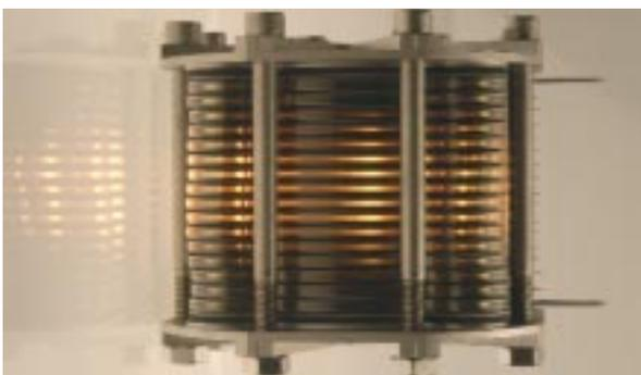
Abb. 2: Der Einsatz von Kunststoff-Bipolarplatten ermöglicht die kostengünstige und montagefreundliche Herstellung von Elektrolysestapeln.
