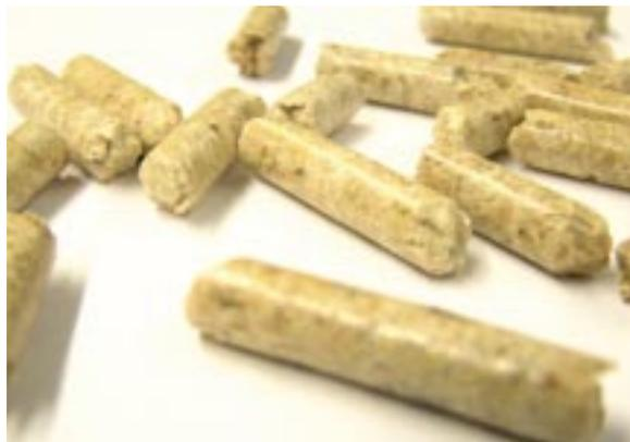
Abb. 2: Holzpellets sind zylinderförmige Stäbchen mit einem Durchmesser von 6 bis 8 mm und einer Länge von 20 bis 40 mm. Sie werden aus Holzabfällen (Sägemehl) durch Pressen hergestellt. Im Gegensatz zu fossilen Energieträgern sind Pellets CO<sub>2</sub>-neutral, weil bei der Verbrennung nur die Menge an Kohlenstoffdioxid freigesetzt wird, die der Baum zuvor beim Wachsen aufgenommen hat.
