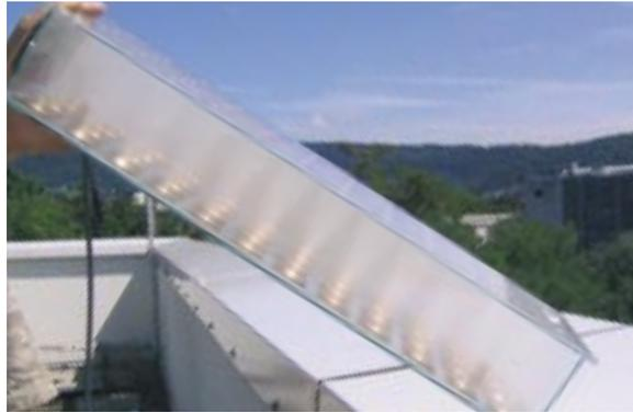
Abb. 2: Photo eines FLATCON<sup>®</sup>-Moduls. Durch das Einbringen von Rauch wird hier die Bündelung der Lichtstrahlen visualisiert. Die Aperturfläche eines Moduls beträgt 768 cm<sup>2</sup> und besteht aus 48 Fresnellinsen mit je 16 cm<sup>2</sup> Fläche. Im Fokus der Linse sitzt eine Konzentratorsolarzelle aus III-V-Halbleitermaterialien.
