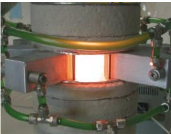
Abb. 1: TPV-Testgenerator am Fraunhofer ISE bei  $1\,200 \text{ °C}$ . Acht GaSb-Module, welche auf Wasserkühlkörper montiert sind, werden konzentrisch um den Strahlungsemitter platziert. Ein GaSb-Modul mit Kühlkörper wurde entfernt, um den glühenden Strahlungsemitter zu zeigen. Die Öffnung beträgt ca.  $5 \times 5 \text{ cm}^2$ .
