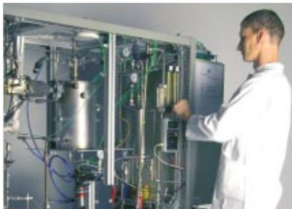
Abb. 1: Vollautomatisierte Anlage zur autothermen Reformierung von entschwefeltem Kerosin Jet A-1 zur Versorgung einer SOFC (im Photo ohne SOFC). Die Anlage ist wärmeintegriert, d. h. die Abwärme der Brennstoffzelle wird in den Reformer zurückgeführt. Die Reformeranlage kann der Last der Brennstoffzelle nachgeführt werden und stufenlos einen Volumenstrom von 10 bis 45 NI/min Synthesegas erzeugen.
