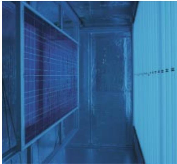
Abb. 1: UV-Prüfstand für Photovoltaik-Module bis zu einer Abmessung von 1,4x2,4 m<sup>2</sup>: Die Intensität der UV-Strahlung ist 50 mal höher als die natürliche UV-B Strahlung und 7 mal höher als die natürliche UV-A Strahlung.
