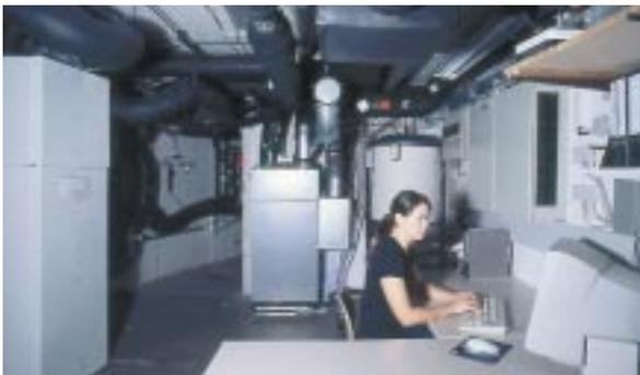
Abb. 1: Auf unserem Teststand messen wir die Energieeffizienz der Gesamtgeräte und ihrer Komponenten. Einerseits können wir stationäre Prüfbedingungen in einer großen Bandbreite wählen. Durch die Automatisierung des Teststands lassen sich andererseits dynamisch veränderliche Bedingungen einstellen, z. B. entsprechend der Norm EN 255-3. Aus den Messungen leiten wir Empfehlungen für das Optimieren der Komponenten und ihres Zusammenwirkens ab.
