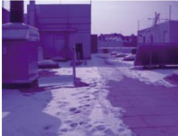
Abb. 1: Durchsicht auf das besonnte Winterdach des Instituts durch den eingefärbten Prototypen eines mit Flüssigkeit durchströmten Verbundglases. Im Hinblick auf hydrostatische und dynamische Belastbarkeit erbrachte dieser Prototyp positive Testergebnisse. Ziel ist der Einsatz als adaptierbare, farbneutrale Sonnenschutzverglasung unter gleichzeitiger Integration von Heiz- und Kühlflächen.
