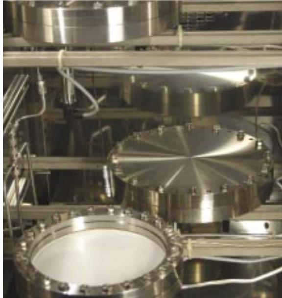
Abb. 1: Permeationsmessstand zur Bestimmung der Durchgangskoeffizienten von verschiedenen Gasen und Wasserdampf durch Folien. Auf einer Seite wird die Konzentration des zu prüfenden Gases eingestellt. Auf der anderen Seite misst ein Massenspektrometer die sich verändernde Gaskonzentration im Probenhalter (Höhe 2 mm). Die Apparatur befindet sich zur Temperierung in einem Klimaschrank.
