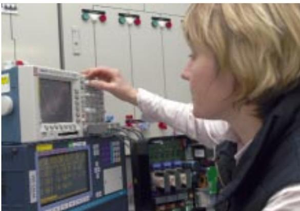
Abb. 2: Das Bild zeigt ein hochpräzises Leistungsmessgerät zur exakten Bestimmung des Wirkungsgrads von Wechselrichtern.
