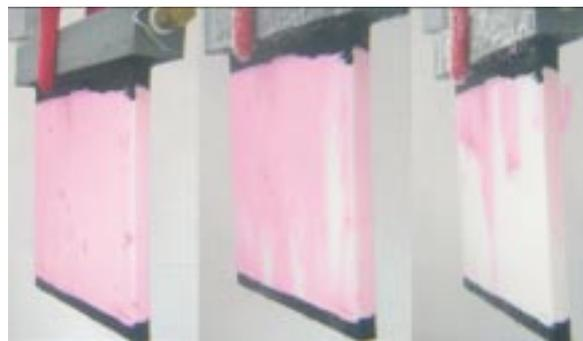
Abb. 2: Durch ein Einfärbeverfahren wird die Wirkungsweise verschiedener Reinigungsverfahren auch optisch analysiert. Dargestellt sind hier drei Phasen des Reinigungsvorgangs an einem keramischen Membranplättchen mit Ultraschall bei einer Frequenz von 1 MHz, die in Abständen von 60 s aufgenommen wurden. Die eingefärbten Deckschichten lösen sich ab und werden von der akustischen Strömung, einer durch die Beschallung entstandenen Fließbewegung, weggespült.
