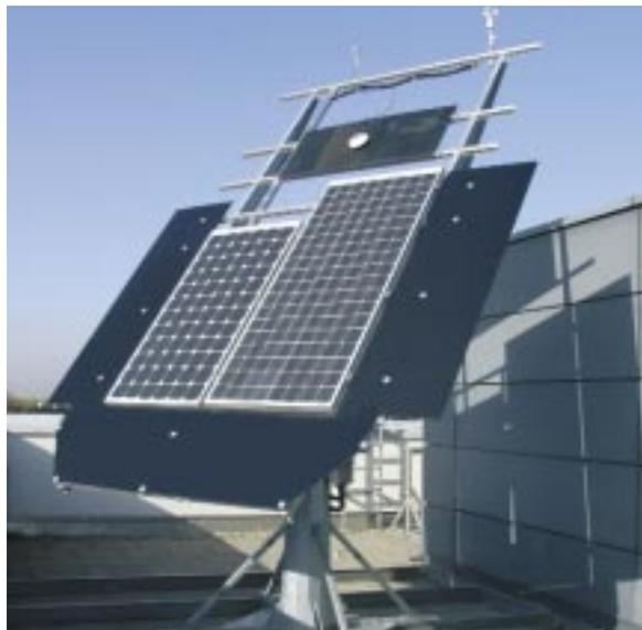
Abb. 2: Prüfstand zur Bestimmung der »nominal operating cell temperature« (NOCT). Der einachsige nachgeführte Tracker ermöglicht eine Verkürzung der notwendigen Prüfzeiten.
