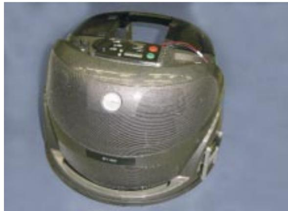
Abb. 3: Das Brennstoffzellensystem wird in den auf dem Photo gezeigten kommerziell erhältlichen Staubsauger-Roboter implementiert. Ein flächendeckendes Navigationsverfahren kartiert den Raum und erlaubt somit die Planung des Lastbedarfs, der vom Brennstoffzellensystem zur Verfügung gestellt werden muss. Beim Überfahren schon gereinigter Gebiete kann die Saugturbine abgeschaltet werden. Durch Einsatz eines Staubsensors wird die benötigte Leistung der Saugturbine ermittelt.
