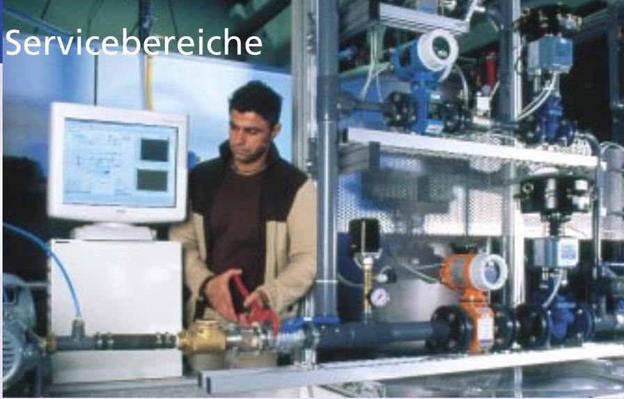
Auf unserem vollautomatisierten Prüfstand werden Kennlinien von Pumpen aufgenommen, Anlaufströme vermessen und das Verhalten der Pumpen unter Belastung ermittelt. Diese Daten fließen dann in eine optimierte Anlagenauslegung ein.
