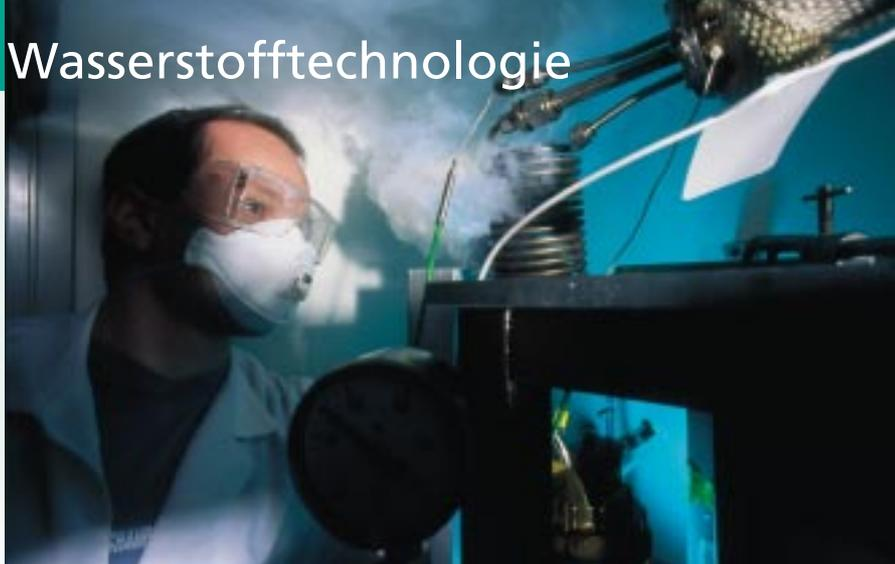
Neuartiges Verfahren zur rückstandsfreien Verdampfung flüssiger Kohlenwasserstoffe: Mit Hilfe eines Katalysators und geringer Luftzufuhr wird Diesel ohne Bildung von Rückständen in die Gasphase überführt. Das dabei entstehende Produktgas wird anschließend in einem Reformierreaktor in Synthesegas für Brennstoffzellen-Anwendungen umgewandelt.
