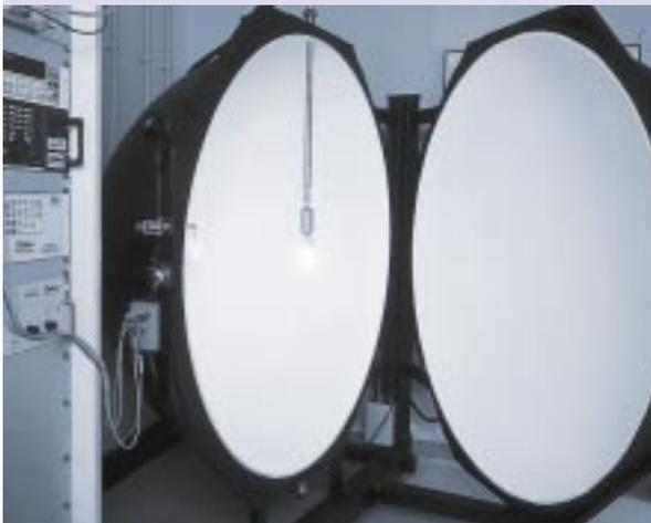
Abb. 1: Kugel-Photometer zur Lichtstrommessung an DC-Lampen und -Leuchten.
