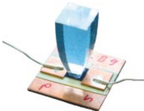
Abb. 1: Zweistufiges photovoltaisches Konzentratorsystem. Trotz einachsiger Nachführung wird eine geometrische Konzentration von über 300 erreicht. Die zweite Konzentratorstufe (CPC) wird direkt auf die speziell hierfür entwickelten Silicium-Konzentratorsolarzellen aufgebracht (siehe unteres Bild). Die nur 4,5 x 4,5 mm<sup>2</sup> großen Zellen weisen einen Wirkungsgrad von 24% bei hundert Sonnen auf.
