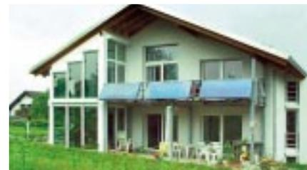
Abb. 1: Passivhäuser aus dem Monitoring-Programm der EnBW Energie Baden-Württemberg AG. Die Wärmeversorgung erfolgt mit erdreichgekoppelten Wärmepumpen, Lüftungsgeräten mit Wärmerückgewinnung bzw. Lüftungskompaktgeräten und thermischen Solaranlagen.
