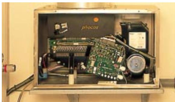
Abb. 3: Am Rappenecker Hof wird eine wasserstoffbetriebene Polymer-Elektrolyt-Membran-(PEM)-Brennstoffzelle (Leistung 1,2 kW) eingesetzt. Die PEM-Brennstoffzelle (Stacks sind im Hintergrund erkennbar) benötigt zum Betrieb reinen Wasserstoff und Luftsauerstoff.
