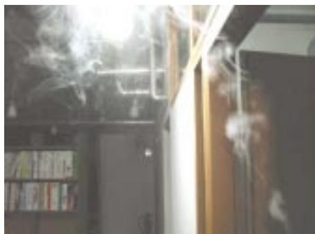
Abb. 2: Visualisierung von Raumlufthströmungen zur Überprüfung des Luftwechsels in Gebäuden.
