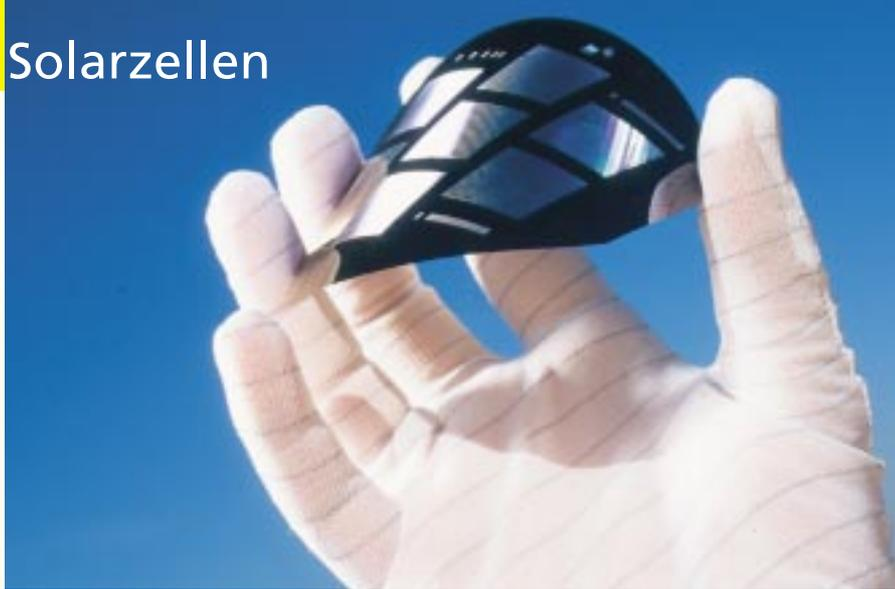
Papierdünne kristalline Siliciumsolarzelle mit industrienahe Zellstruktur (lasergefeuerte Rückseitenkontaktpunkte). Trotz einer Dicke von weniger als 50  $\mu\text{m}$ , wurde ein Wirkungsgrad von mehr als 20% erreicht.
