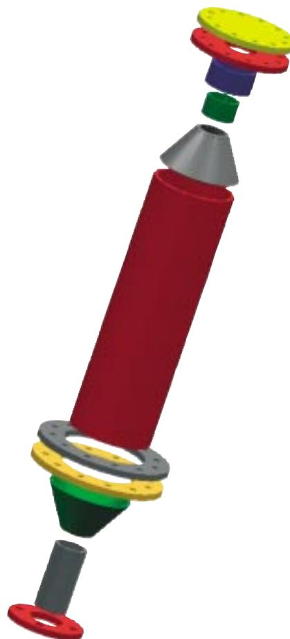
Abb. 1: Explosionszeichnung des Reaktors. Einlass oben, Auslass unten. Die Reaktorwabe ist nicht gezeigt. Der Durchmesser des Reaktorrohrs beträgt 124 mm und die Länge 400 mm.
