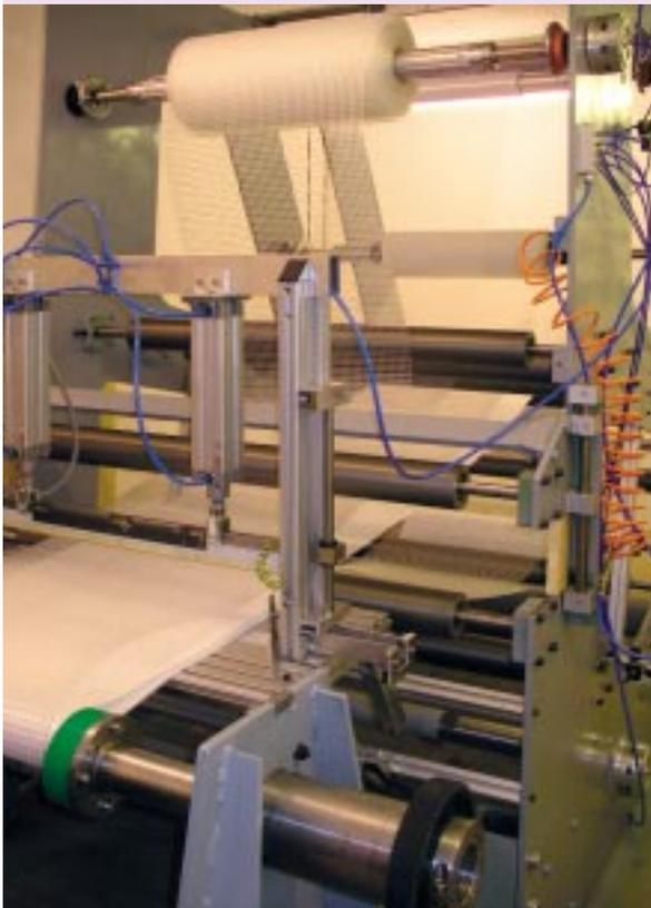
Abb. 1: Ansicht der Wickelmaschine zur Herstellung von Membrandestillationsmodulen. Die Maschine verfügt über acht Wellen zur Aufnahme von Materialrollen und zehn Leitwalzen, die das Material zu einem Verbund zusammenführen. Mit der Maschine können Prototypen und Kleinserien gefertigt werden.
