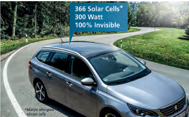
Unsichtbare, hocheffiziente Solarzellen in einem Autodach. © Fraunhofer ISE
