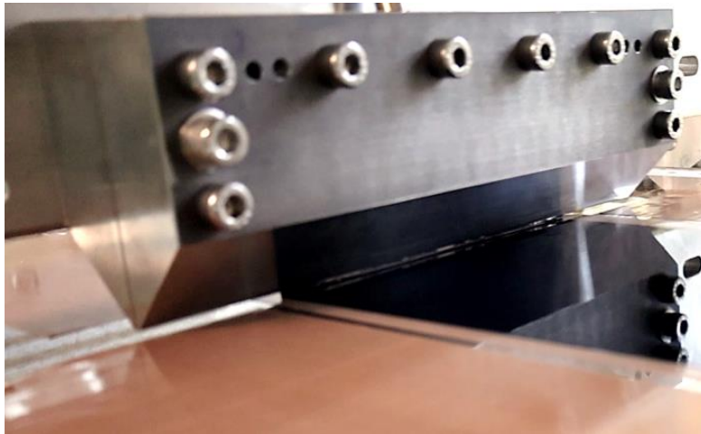
Abb. 4.5 Schlitzdüsen-Beschichtung mit 150 mm Breite für „Generic Stack“-Format
