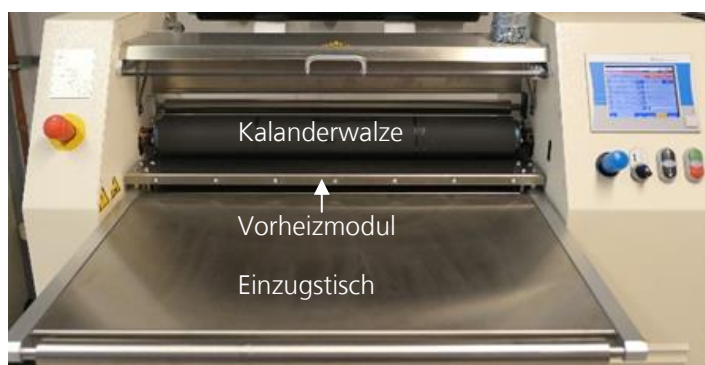
Abb. 5.2 Frontansicht des Rollenkalanders mit integriertem Vorheizmodul
