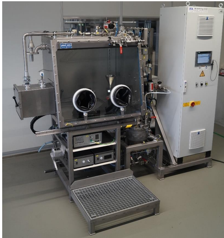
Abb. 3.14 Gemeinsam mit dem Projektpartner IFA entwickelte und von IFA konstruierte Pilot-Mischanlage. Zu sehen sind links das Glove-box-System für die Dosierung der Komponenten, mittig/unten der Mischkessel und rechts der Schaltschrank mit dem Bedienfeld.
