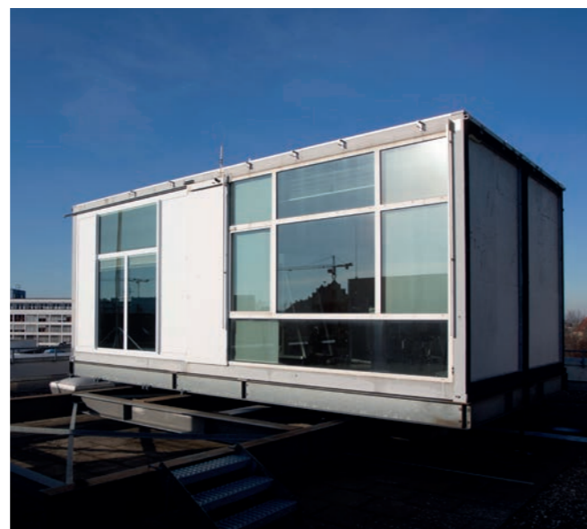
Teststand mit zwei drehbaren Testräumen für thermische und visuelle Komfortuntersuchungen.
