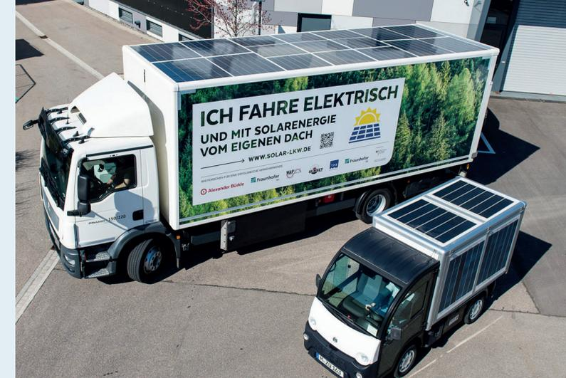
*E-LKW und Mini-E-LKW mit Photovoltaikmodulen.*
