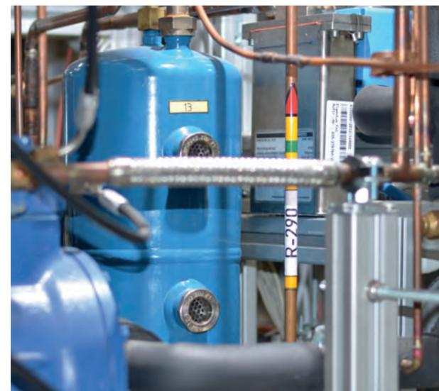
können luftbeaufschlagte Geräte und Komponenten auch in einer der drei Luftstrecken bei Luftdurchsätzen bis zu 5000 m<sup>3</sup>/h, Temperaturen von -15 °C bis 50 °C und Luftfeuchten von 15 % bis 95 % getestet werden. Für die Konditionierung von Wasser oder Sole stehen mehrere Anlagen zur Verfügung, die das entsprechende Medium auf Temperaturen von -25 °C bis +95 °C im Leistungsbereich bis 75 kW thermisch bereitstellen und Volumenströme bis 9 m<sup>3</sup>/h erreichen können.
