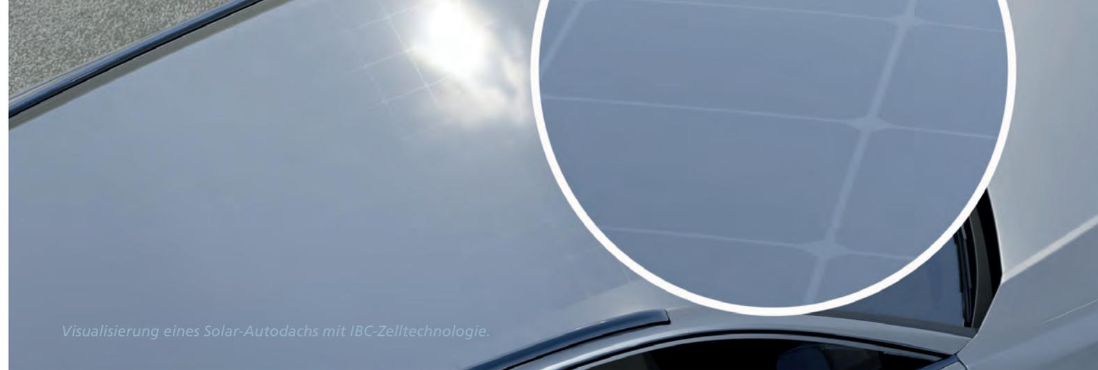
Visualisierung eines Solar-Autodachs mit IBC-Zelltechnologie.
