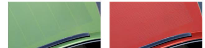
Visualisierung eines Autodachs mit (links) Schindeltechnologie und (rechts) Drahtverschaltungstechnologie.
