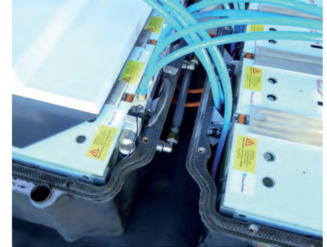
*Flüssigkeitsbasiertes Kühlsystem für Lithium-Ionen-Batterien.*
