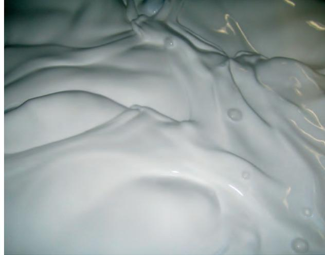
*PCM-Slurry in einem Speichertank.*
