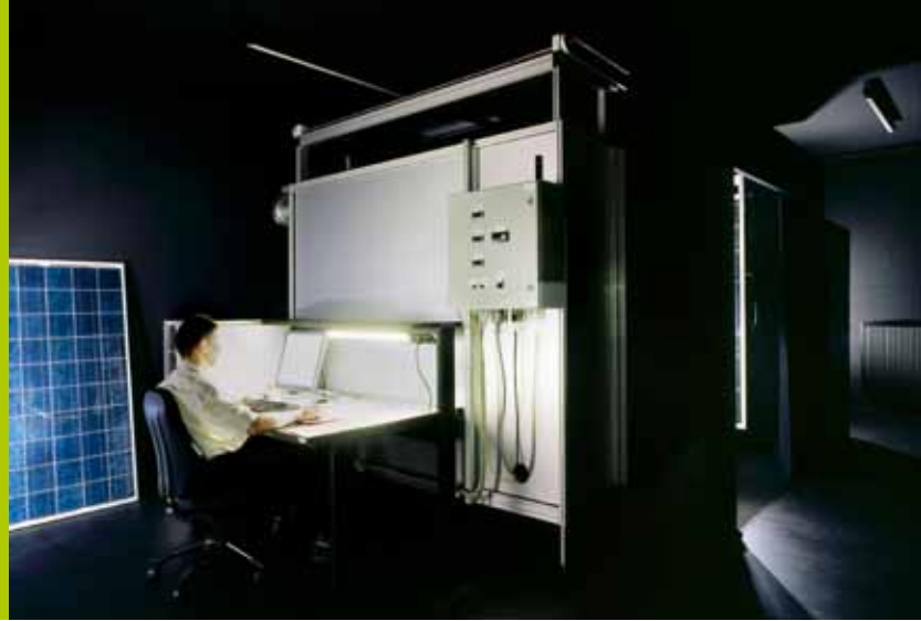
2 Einzelmodule können in unserem Messlabor mit sehr hoher Präzision von +/- 2 % auf einer Fläche von 4 m 2 gemessen werden.
