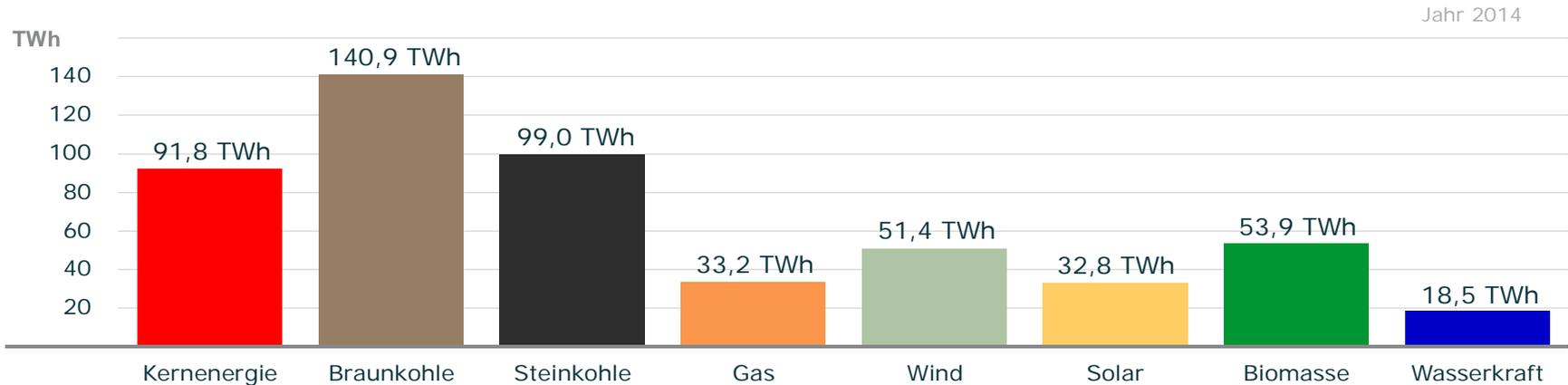
Die Grafik zeigt die Nettostromerzeugung aus Kraftwerken zur öffentlichen Stromversorgung. Die Erzeugung aus Kraftwerken von „Betrieben im verarbeitenden Gewerbe sowie im Bergbau und in der Gewinnung von Steinen und Erden“ ist bei dieser Darstellung nicht berücksichtigt.
