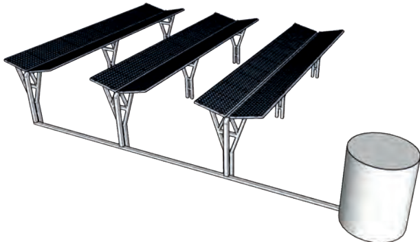
Abb. 55: Konzept einer Regenauffangvorrichtung mit Speichertank © Fraunhofer ISE
