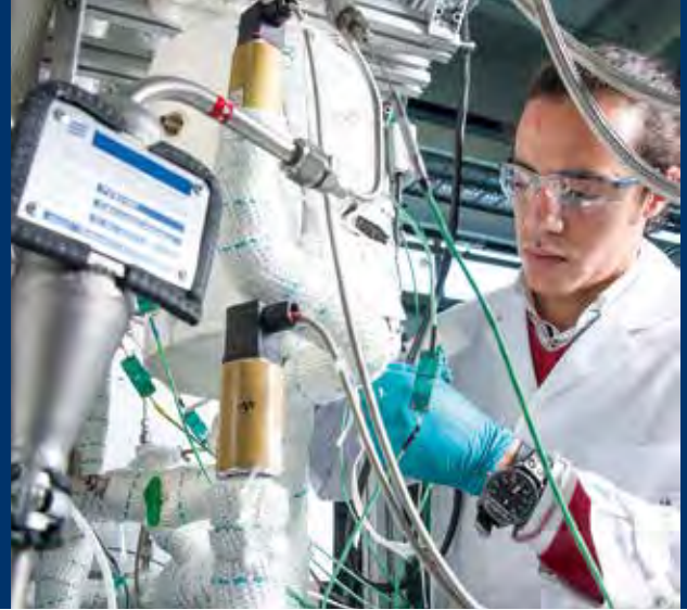
Detailausschnitt einer Miniplant-Anlage am Fraunhofer ISE zur Herstellung von Methanol und Dimethylether (DME) unter Verwendung von Kohlendioxid und Wasserstoff.
