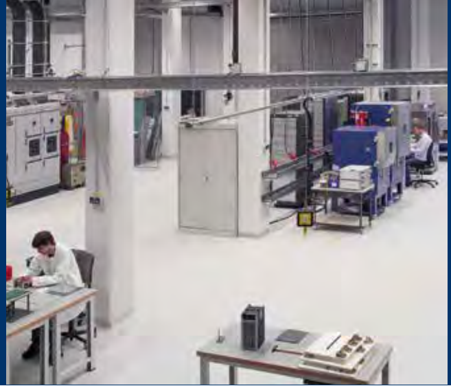
Innenansicht des ServiceLab Batteries am Fraunhofer ISE. Dort stehen umfangreiche Prüfmöglichkeiten für Zellen, Batteriemodule und Gesamtsysteme mit bis zu 1000 V und 0,25 MW zur Verfügung.
