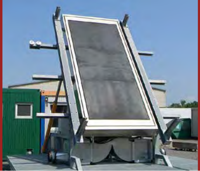
OFREE-Prüfstand (Outdoor test Facility for Real-size building Envelope Elements) für Fassadenelemente bis zu 4 m x 3,77 m (hier ohne Fassadenelement). Gut sichtbar ist die schwarze Kalorimeteroberfläche sowie die I-Träger des Trackers, auf denen das rechteckige Kalorimeter befestigt ist. Die Bewicklungseinheit für den definierten äußeren Wärmeübergangskoeffizienten wird ebenfalls erst nach dem Fassadenelement montiert.
